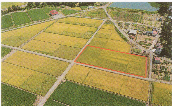
写真 切り土と盛り土のために水稻の生育ムラが見られる大区画水田(刈り取り20日前) (淡色部:切土部, 濃色部:盛土部)
