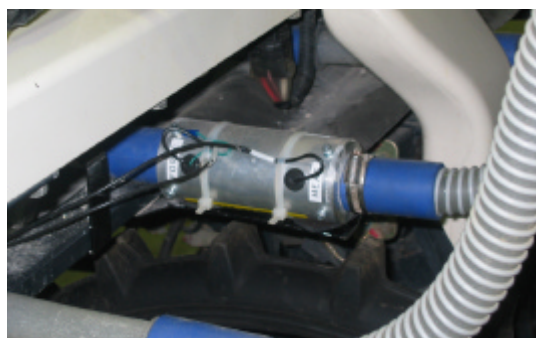
図2 搬送管路に取り付けた測定電極
