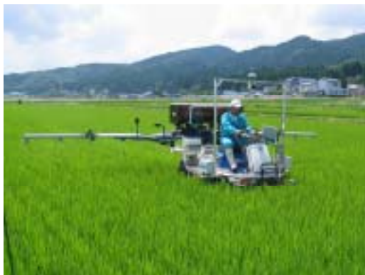
図1 地点ごとに適正な施肥を行う自動可変施肥作業 (GPS を用いた精密栽培管理)
