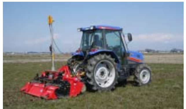
図3 開発機による耕盤均平耕うん作業
