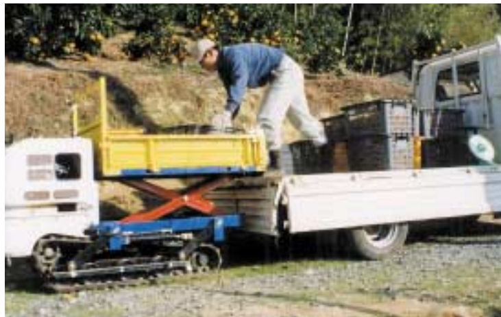
写真10 歩行形体系のコンテナ積み替え作業
