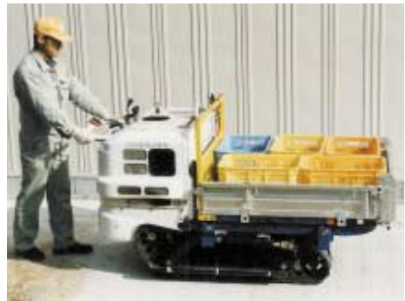
写真6 クローラ式小形運搬車の外観
