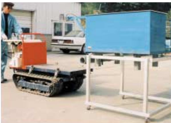
写真4 散布装置の脱着方法
