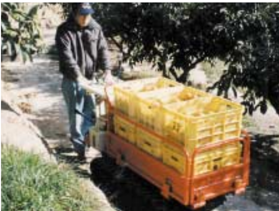
写真6 クローラ式小形運搬車の外観
