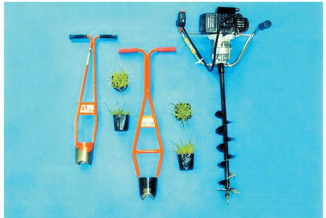
写真13 植え込みの道具。既耕地用ホーラー（左），未耕地用ホーラー（中），エンジン式穴掘り機（右）。
