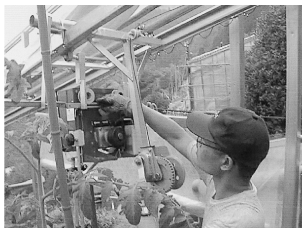
写真16 ウインチ利用手動台車によるレール間移動
