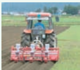
図2 耕うん同時畝立て播種機(3条)による大豆の播種作業
