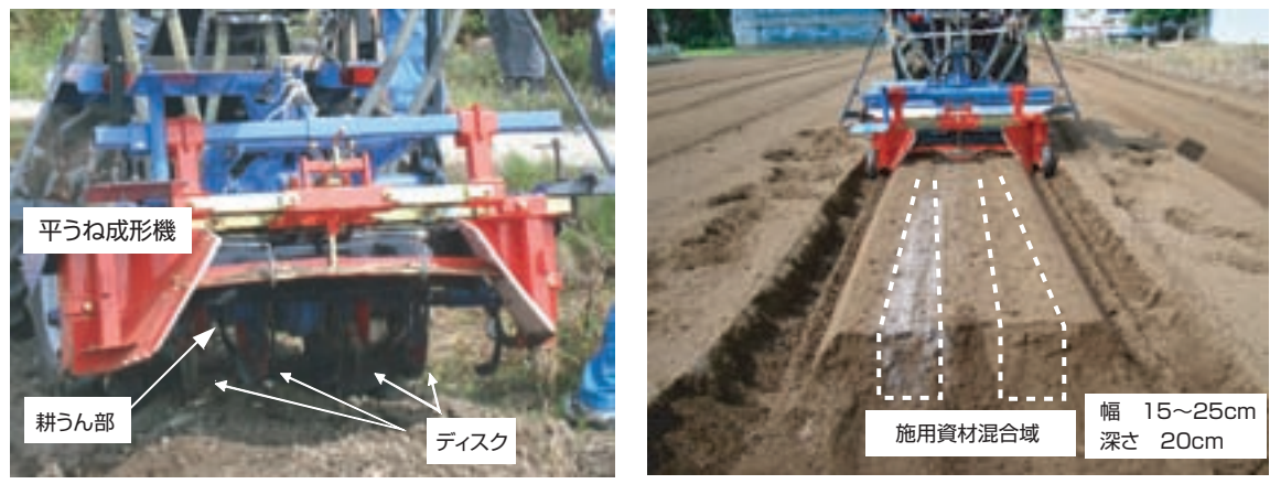
図3 平うね施用機の部分施用部と施用資材の混合域
