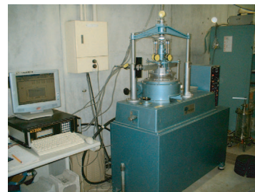
写真2 パラメータの実測（リングせん断試験）
