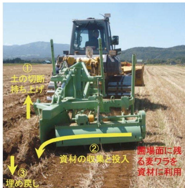
写真1 カッピングソイラ工法の施工手順
