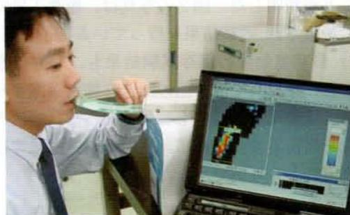
図1. MSCAN 2シートセンサ(上)と臼歯による咀嚼実験風景(下)
