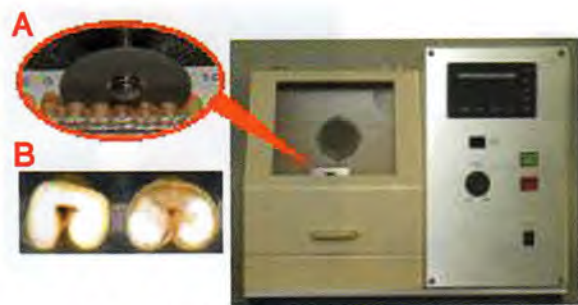
図2 実用化した穀粒切断装置 (Grain Cutter NFC02, 千穂田精衡) と小麦の切断試料 ダイヤモンドディスクを用いた切断部(A)で穀粒の平滑な分析面を調製する(B)。
