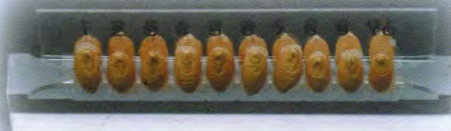
ホルダーに固定した穀類の切断と胚部の回収
