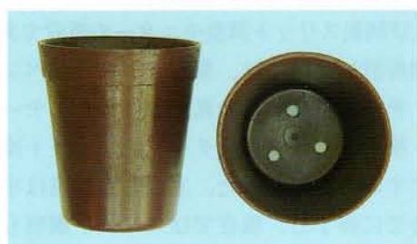
図4 射出成形法を用いた生分解性育苗ポット —原料:コーングルテンミール、オカラ、グリセリン等—
