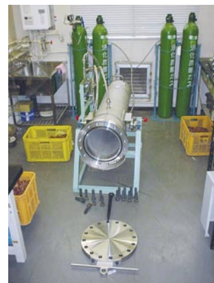
図4 大型高圧炭酸ガス処理装置 (直径40cm・長さ155cm)
