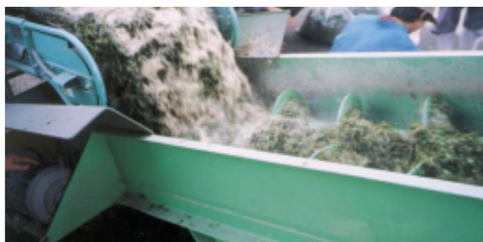
2軸スクリュ式混合機による混合作業
