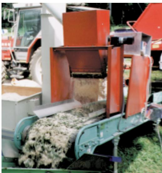
材料草流量計測装置および配合飼料添加装置
