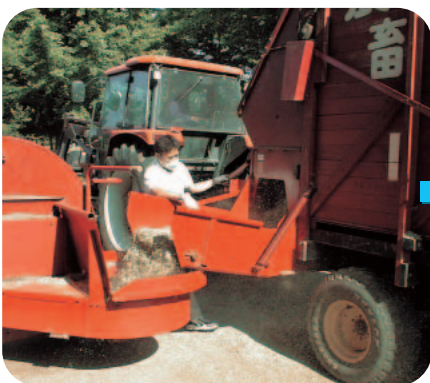
以前行っていた作業の様子 (トラクター操作担当と牧草供給量 制御担当の2名で実施)
