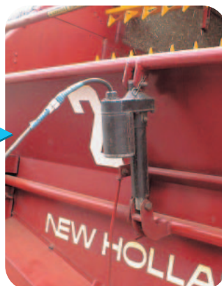
クロップキャリアに取り付けた 「牧草排出量遠隔制御装置」
