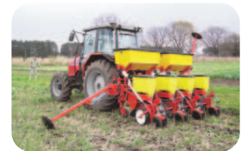
図 不耕起播種機による秋作ムギ収穫跡地に対するトウモロコシ播種
