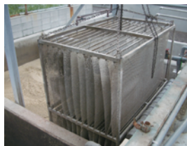
▼養豚農家における実証試験の様子2 結晶化装置に浸漬する付着回収用部材
