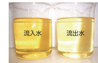
図2 開発した装置による着色の低減例
