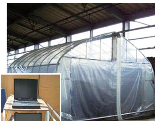
図1 堆肥化処理からの温室効果ガス測定（大型チャンバーとマルチガスモニタ）
