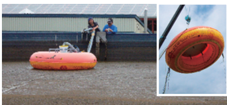
図2 スラリー貯留からの温室効果ガス測定（浮上チャンバー）
