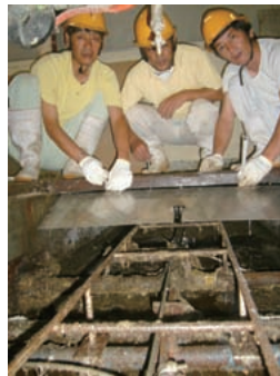
図1 スクレーパにつけたガイドが侵入防止扉を押し上げて鶏舎内にもどる
