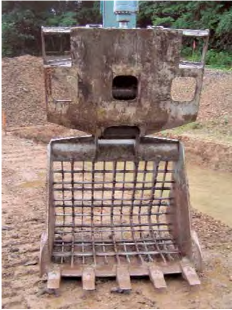
Photo.4 解砕バケット (スケルトンバケット+押土板) Bucket type crusher (skeleton bucket with pushing plate)
