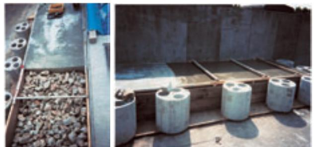
Photo 3-1 粗骨材 (左) と完成後の実験用コンクリート供試体 (右)
