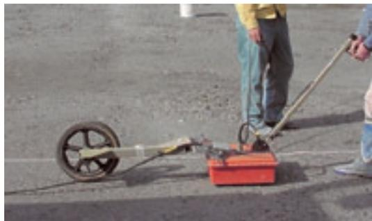
Photo 3-3 地中レーダシステムのアンテナ
