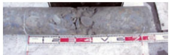
Photo 3-6 地中レーダによる反射異常箇所のコア採取結果
