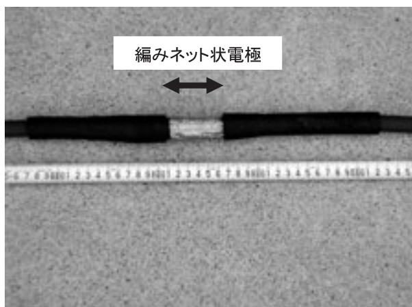
**Photo 4-4** 埋設した電線・電極
