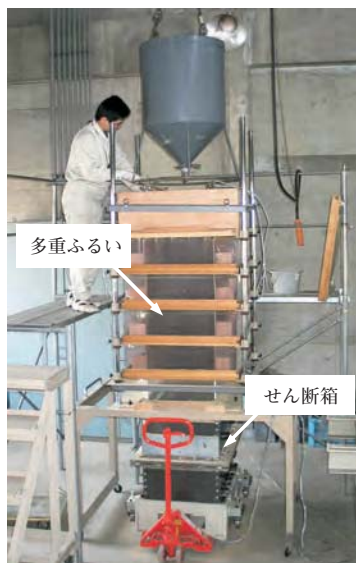
Fig. 42 多重ふるい法による豊浦砂の供試体の作成 Procedures to make Toyoura sand specimen by the multi sieves method
