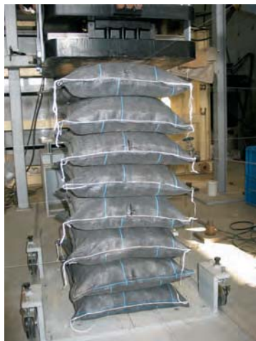
Fig. 142 土嚢積層体の圧縮試験の様子 Vertical compression test for a pile of soil bags
