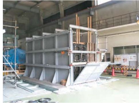
(b) 土槽の外観
