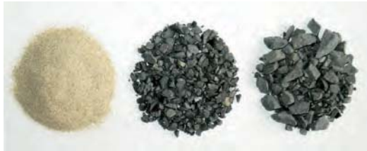
Fig. 9 大型 DS 試験で使用した粒子径が異なる 3 種類の砂礫材 Three types of granular materials with different particle sizes used in the large direct shear test
