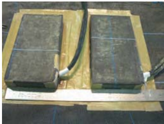
Fig. 199 2方向ロードセルを土嚢袋内側に取り付けた状況 Installation of two-direction load cells into soil bag
