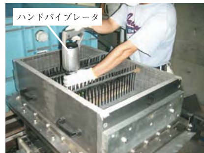
Fig. 43 重量 6.6kgf のハンドバイブレータを用いた礫材による地盤作成の様子 Procedures to make the gravel specimen with a 6.6 kgf weight handy vibrator
