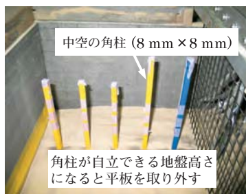
Fig. 46 色砂を豊浦砂の供試体内に挿入する方法(その2) Incorporation of colored sand into Toyoura sand specimen
