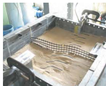
Fig. 49 浸潤後の豊浦砂による供試体観察面を切り出した様子 Observation plane with excavation of the unsaturated Toyoura sand specimen
