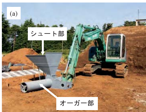
Fig. 260 中詰め材投入機を用いた土嚢の作成方法 : (a) 中詰め材投入装置をバックホウに取り付けた様子 ; (b) 再生砕石を土嚢袋に投入している状況
