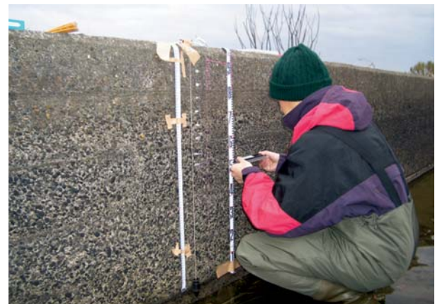
Fig.22 型取りゲージによる水路壁面の凹凸測定 Roughness Measurement of Canal with Roughness Profile
