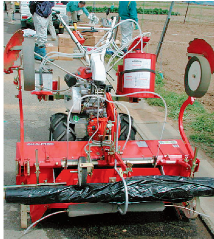
図8. 試験に使用したマルチ同時灌注機
