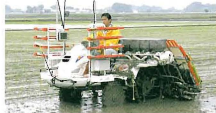
可変施肥装置を搭載した側条施肥田植機
