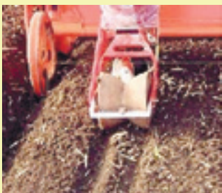
山型鎮圧輪による鎮圧
