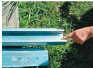
図2 薄板軽量形鋼 (89mm×40mm (45mm)×1.6mm、 亜鉛メッキ (Z27))
