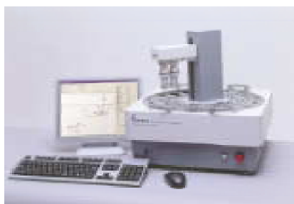
図1 味覚センサー装置（味認識装置SA402B、写真はインテリジェントセンサーテクノロジー社提供）
