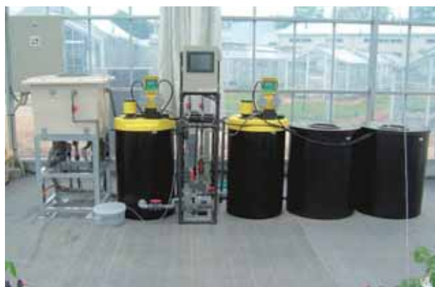
図2 養液栽培装置
