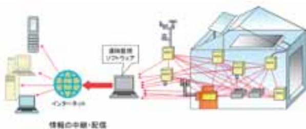
図1 遠隔監視ソフトウェアの概念図
