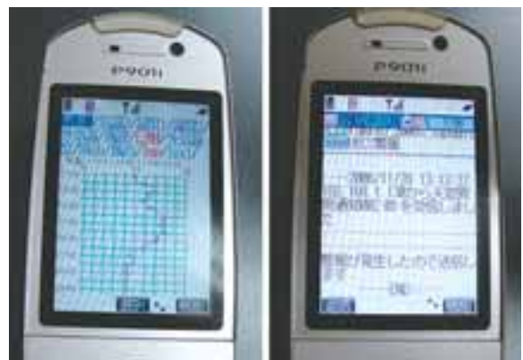
図3 遠隔監視ソフトウェアの配信するグラフと警報メール
