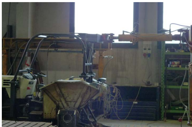
図1 CROPS 後部負荷試験の様子
