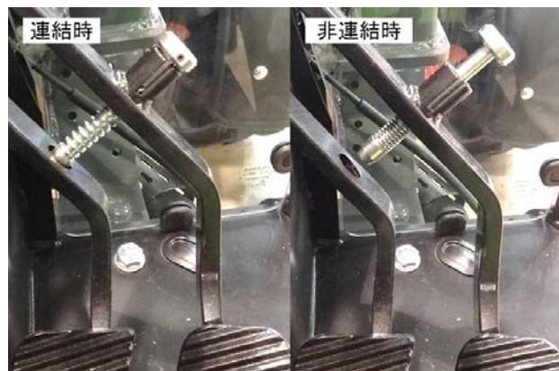
図2. 片ブレーキ連結装置
