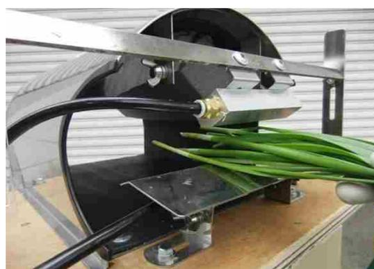
図2 上下ノズル間にニラを挿入した様子
