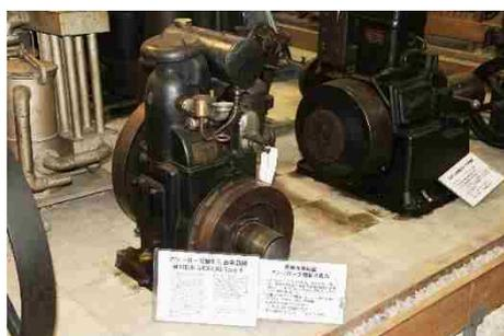
図2 揮発油発動機（1928年頃輸入）（左）とデイゼル機関（昭和初期輸入）（右）
