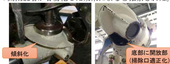
図2 穀粒の残りにくい機内構造の例
