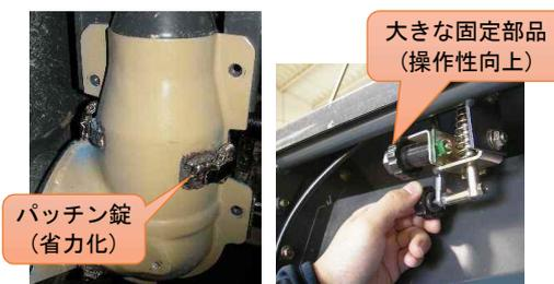
図3 開閉簡便な掃除口の例
