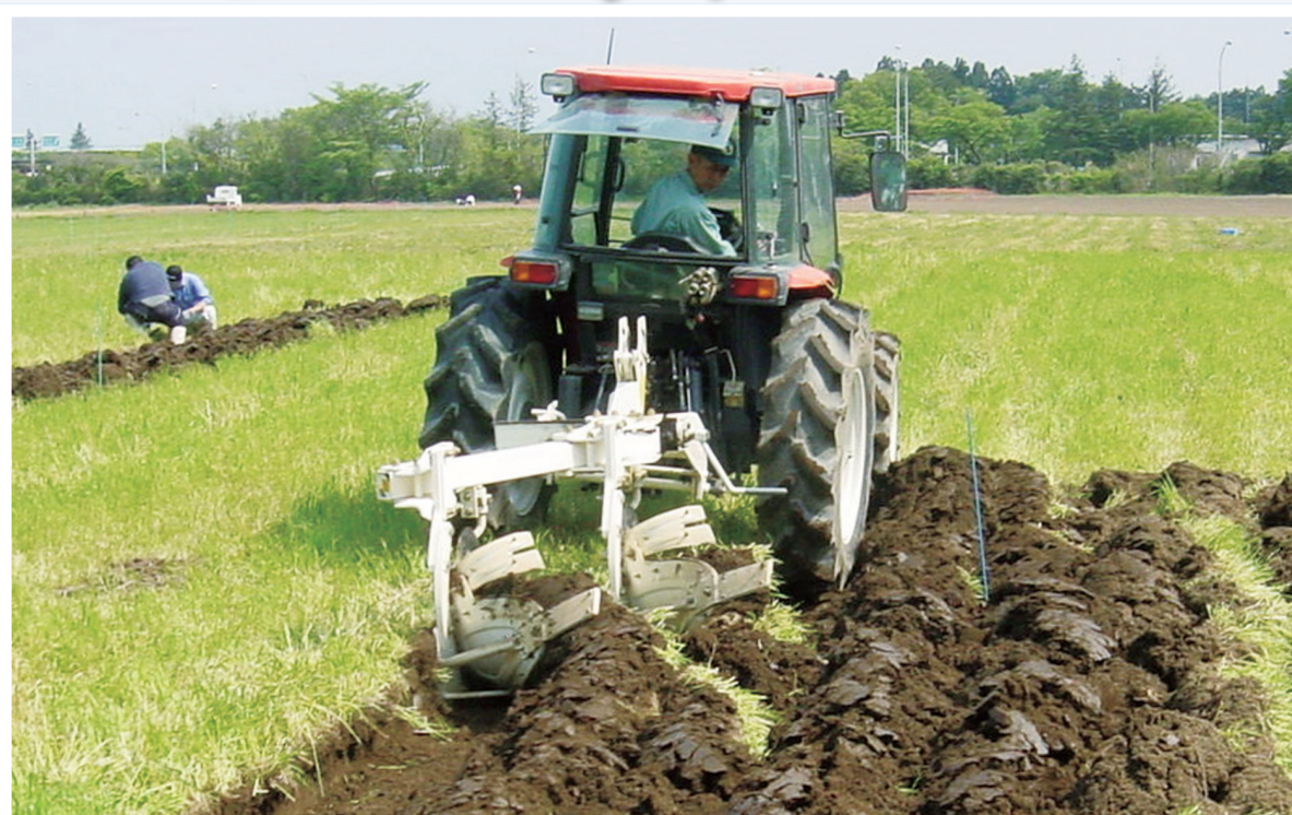
耕起方法の違いによる土壌の放射線遮蔽効果の検証（ブラウ耕作の様子）
