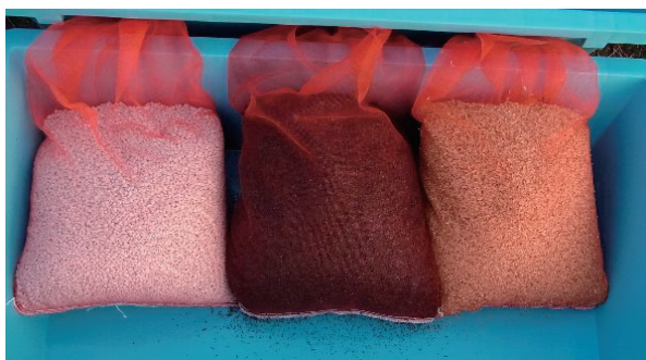
Fig.3 供試した吸着・ろ過資材 Adsorption filtering medium used to experiment (左からゼオライト, くん炭, モミガラ)
