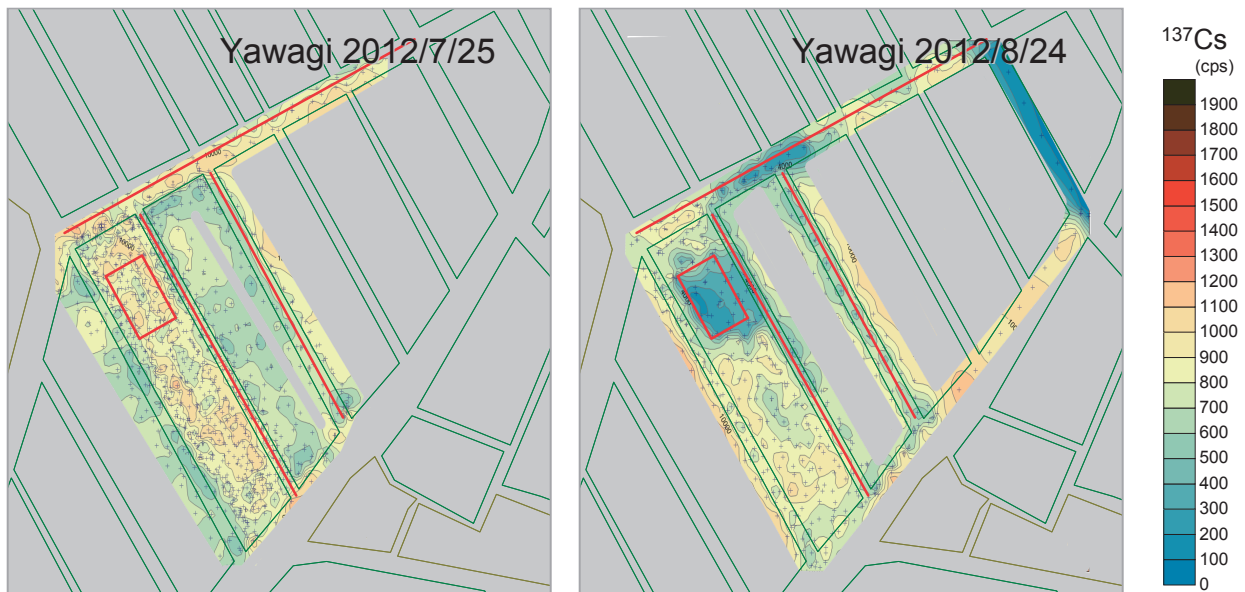
Fig.21 八和木地区の農地測定における 137 Csピークカウント数の分布 (左から八和木1, 八和木2) Distributions of 137 Cs peak counts in the Yawagi farm-surface observations
