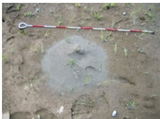
Fig.51 噴砂の事例（松ヶ崎池） Example of boiling sand
