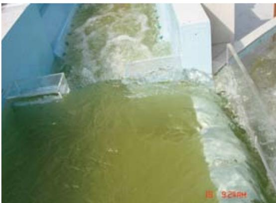
Fig.7 横越流堰の下流端における局所的な水面上昇
