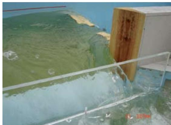
Fig.16 横越流堰の下流端における流況 (改良型 I)
