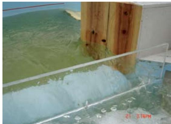
Fig.17 横越流堰の下流端における流況 (改良型 II)
