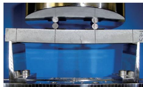
**Fig. 3** 縮小試験体の試験状況
