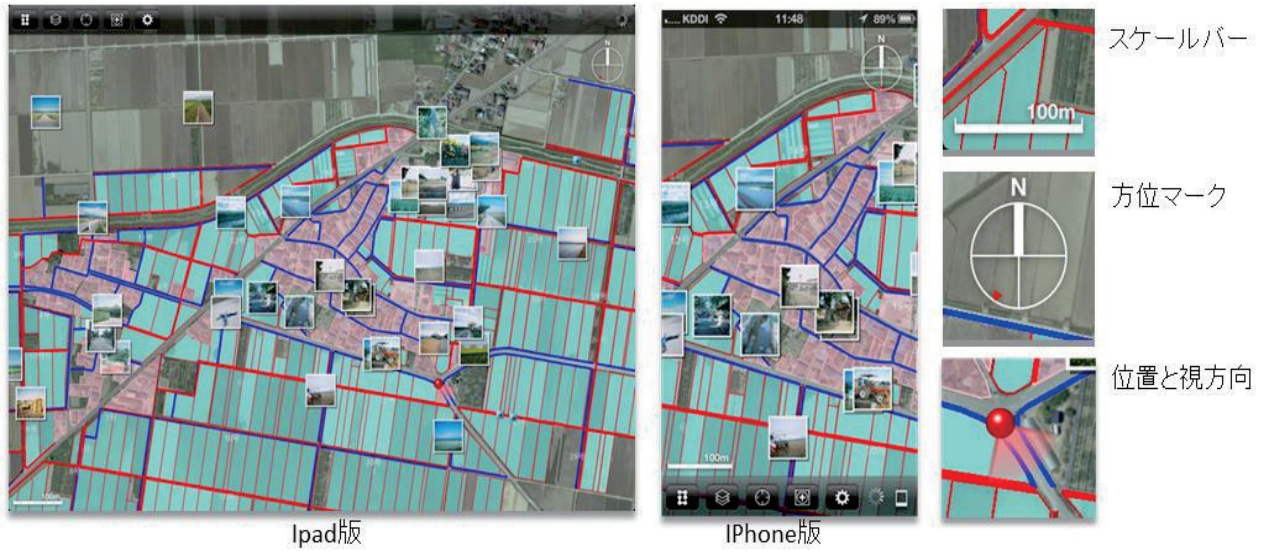
Fig. 16 GIS 地図画面の構成 (iPad) Composition of a GIS map screen (iPad)
