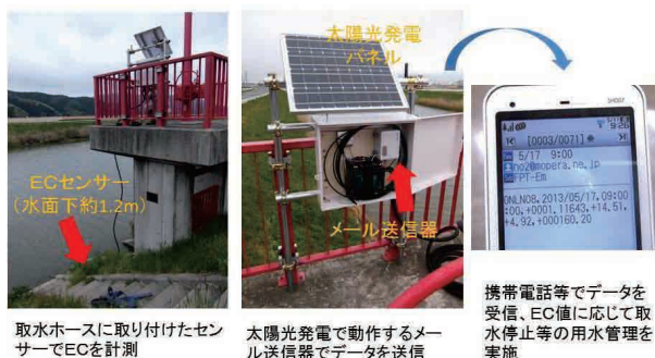
Fig.3 ECデータ送信システム EC data-mail sending system
