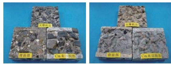
Fig. 86 実水路摩耗面および促進摩耗試験後試験体
