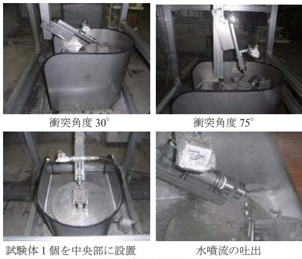
試験体 1 個を中央部に設置
