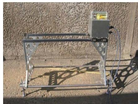
Fig. 9 摩耗形状計測装置
