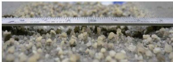
Fig. 47 M50 の摩耗状況 (28 日後)
