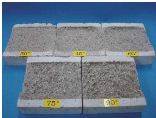
Fig. 81 JIS モルタルの試験後の表面状況
