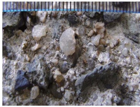
**Fig. 102** E地区採取コアの実摩耗表面および促進摩耗表面の比較
