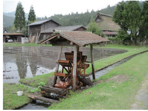
Fig. 79 揚水水車 (B 形式 : 京都府京都市) IWW (B-type in Kyoto, Kyoto pref.)
