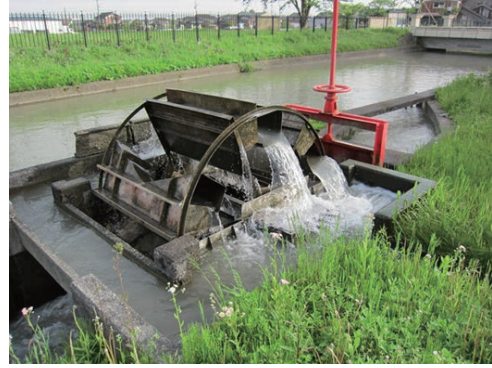
Fig. 78 揚水水車 (B 形式 : 富山県富山市) IWW (B-type in Toyama, Toyama pref.)
