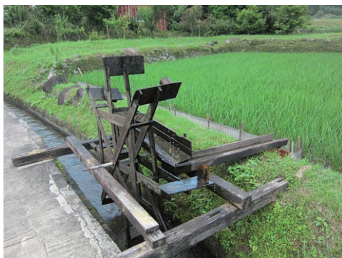
Fig. 77 揚水水車 (H 形式 : 三重県津市) IWW (H-type in Tsu, Mie pref.)
