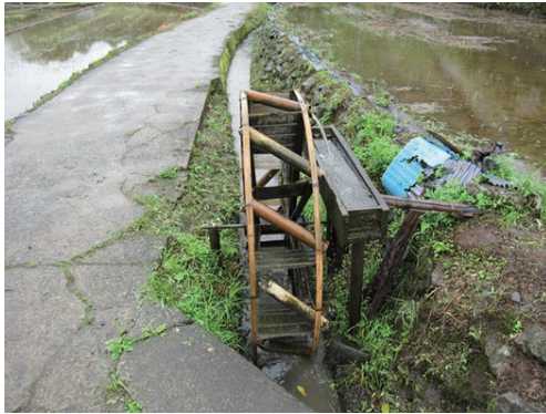
Fig. 75 揚水水車 (V 形式 : 熊本県水俣市) IWW (V-type in Minamata, Kumamoto pref.)
