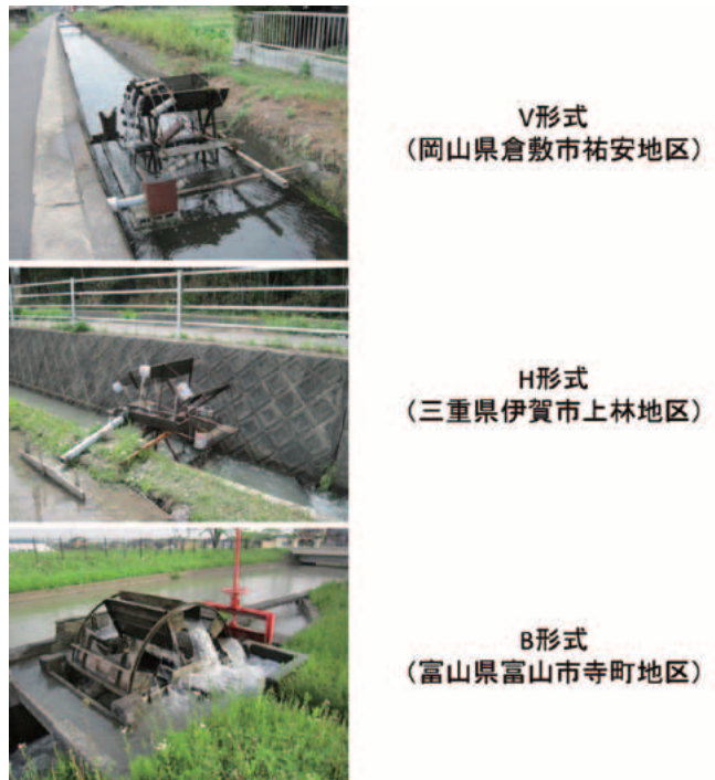
Fig. 10 筒の設置方法による分類 Variety of IWW
