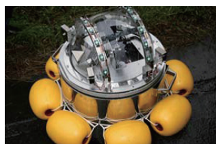
水路トンネル点検用 無人調査ロボット
