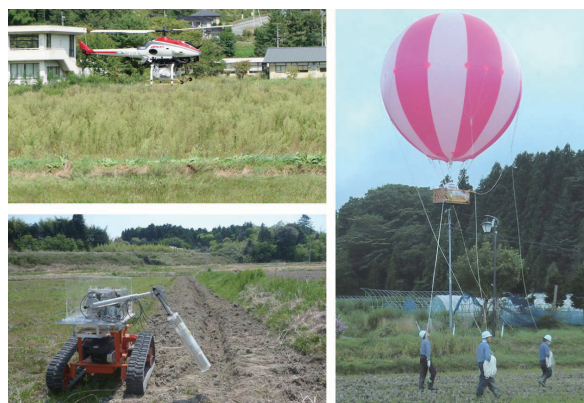
写真2 気球（右）、無人ヘリ（左上）、ラジコン移動車（左下）に搭載した測定状況
