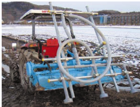
写真 3列ノズルをトラクターに取り付けた状況
