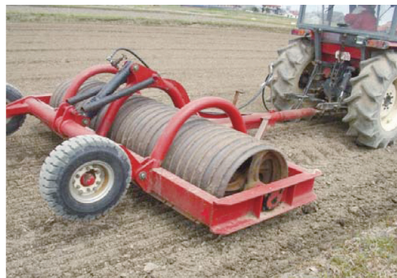
図1-1-13 ケンブリッジローラによる鎮圧作業
